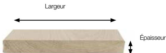
Exemple: un parquet en chêne massif d'une largeur de 200 mm et d'une épaisseur de 20 mm a un facteur d'élanement de 10 (= 200/20)
